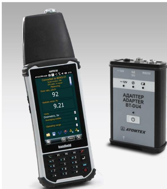
БОИ4 представляет собой карманный персональный компьютер (КПК) со встроенным узлом детектирования, обеспечивающем измерение дозы и мощности дозы гамма-излучения в месте нахождения оператора.
