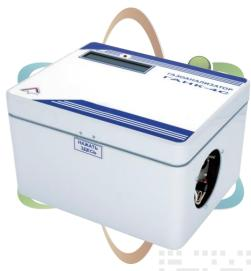
Газоанализаторы стационарные ГАНК-4С, ГАНК-4СЕх предназначены для автоматического измерения содержания различных веществ и выдачи показаний физических факторов в воздухе рабочей зоны, в закрытых (замкнутых) помещениях, в промышленных выбросах, вентвыбросах и в технологических процессах в целях охраны окружающей среды, обеспечения безопасности труда и оптимизации технологических процессов
