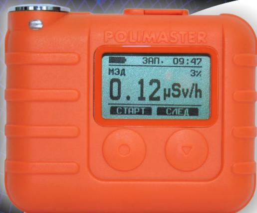
**Индивидуальные дозиметры РМ1610В/В-01 предназначены для измерения индивидуального эквивалента дозы (ЭД) и мощности индивидуального эквивалента дозы (МЭД) непрерывного и импульсного рентгеновского и гамма-излучений.**
