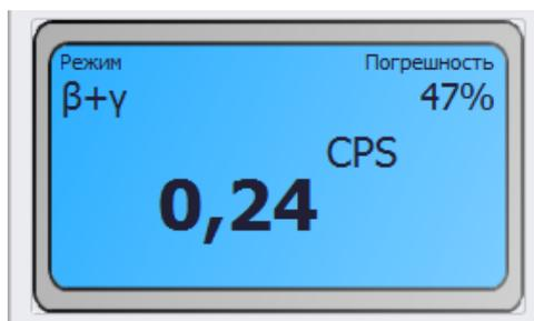
Экран отображает результат измерения плотности потока  $\beta$ -частиц в  $\text{мин}^{-1}/\text{см}^2$ .
