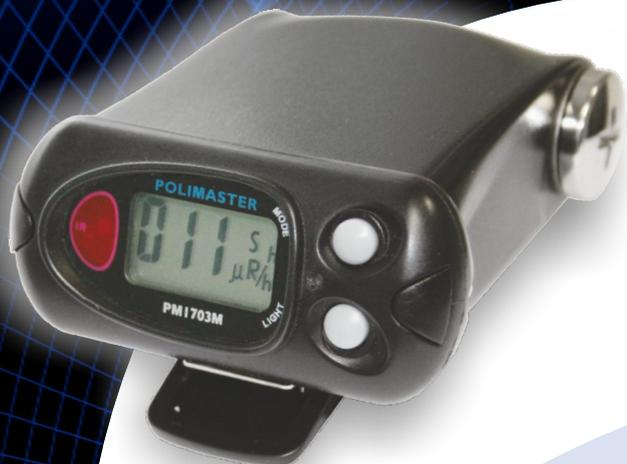
Энергокомпенсированный дозиметр PM1703MO-1 предназначен для поиска и локализации радиоактивных источников и измерения мощности эквивалентной дозы (МЭД) до 10Зв/ч.
