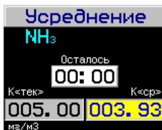
Рисунок 2.14 Вид дисплея газоанализатора в режиме измерения средневзвешенных концентраций
