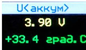
Рисунок 2.11 Пример отображения данных о напряжении аккумуляторной батареи на дисплее газоанализатора
