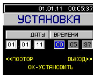
Рисунок 2.10 Установка даты и времени в газоанализаторе
