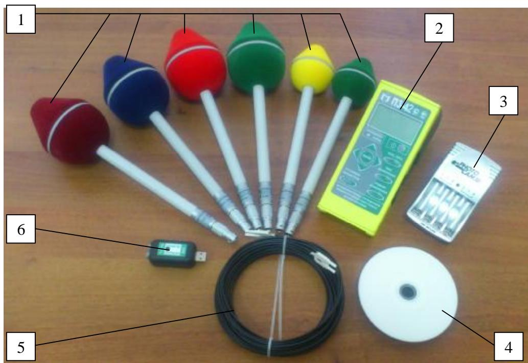
1 – антенны-преобразователи АП-6, АП-5, АП-4, АП-3, АП-1, АП-2
