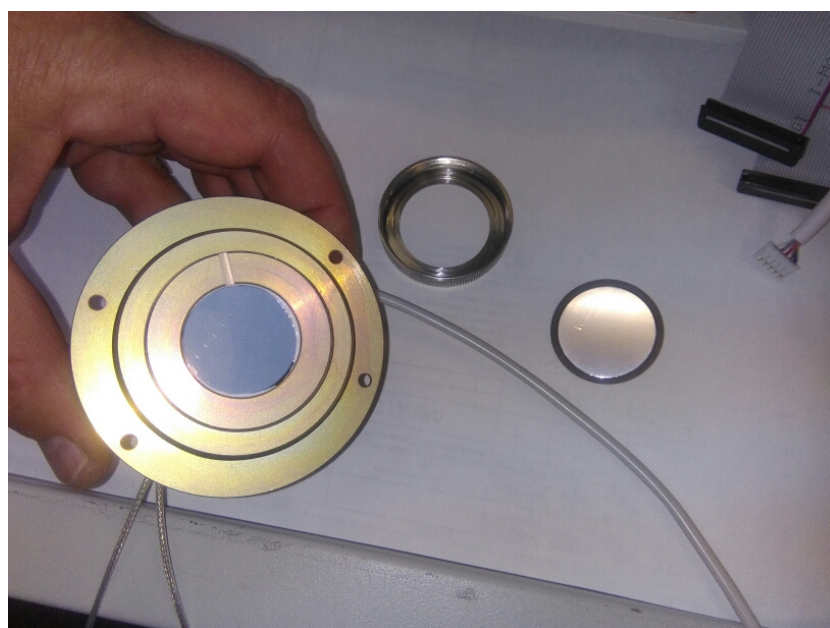
Рисунок 3.4 – Замена защитного кольца с плёнкой
