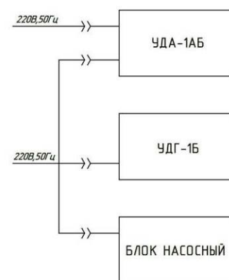
Рисунок А.2 – Схема подключения и габаритные размеры в случае работы установки УДГ-1Б с насосным блоком БН-01 и установкой УДА-1АБ
