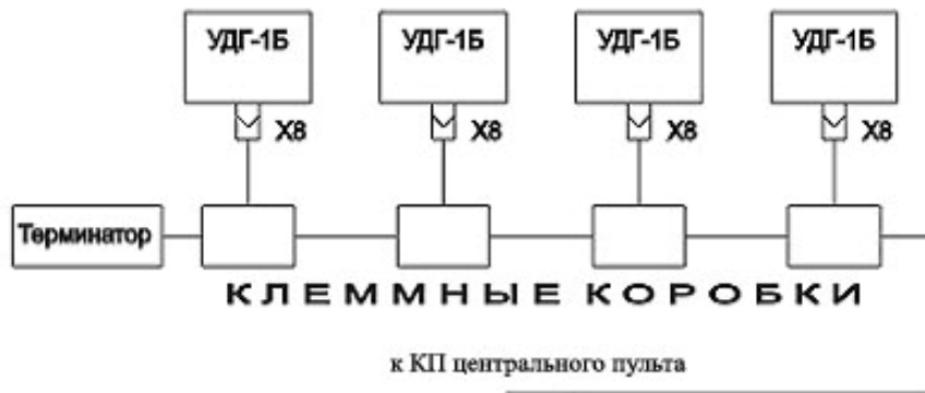
Схема объединения УДГ-1Б в сеть RS-485
