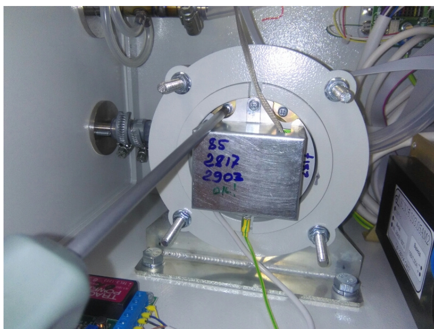
а) – Откручивание крепежных винтов блока детектирования
