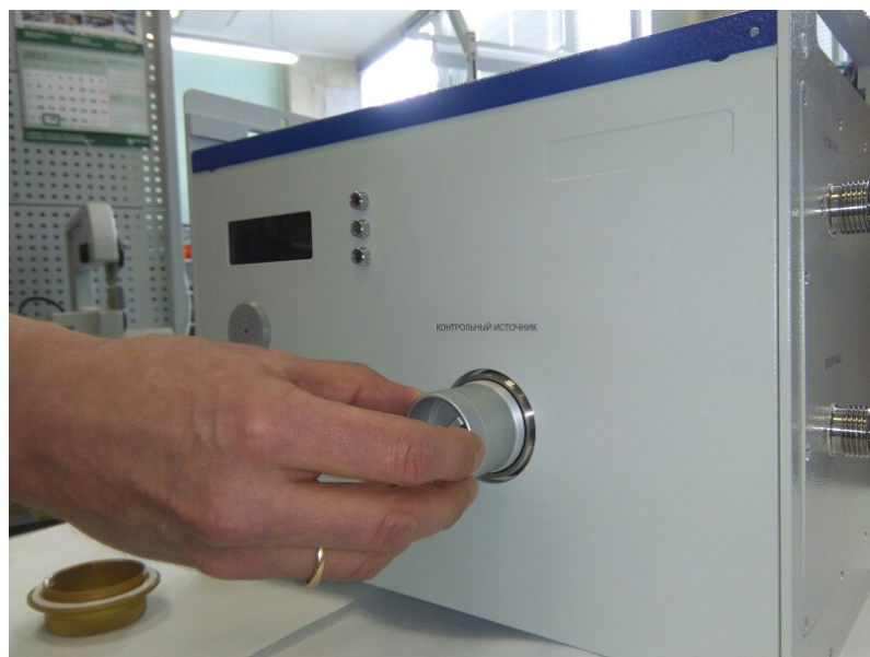
Рисунок 4.3 – Установка контрольного источника на штатное место
