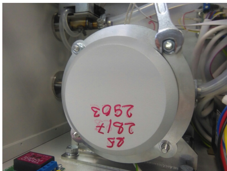
а) – Откручивание крепежных гаек защиты блока детектирования
