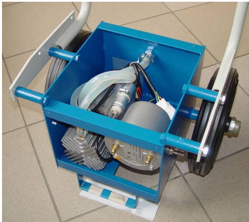
Рисунок 3.1 – Съем передней и верхней панелей блока
