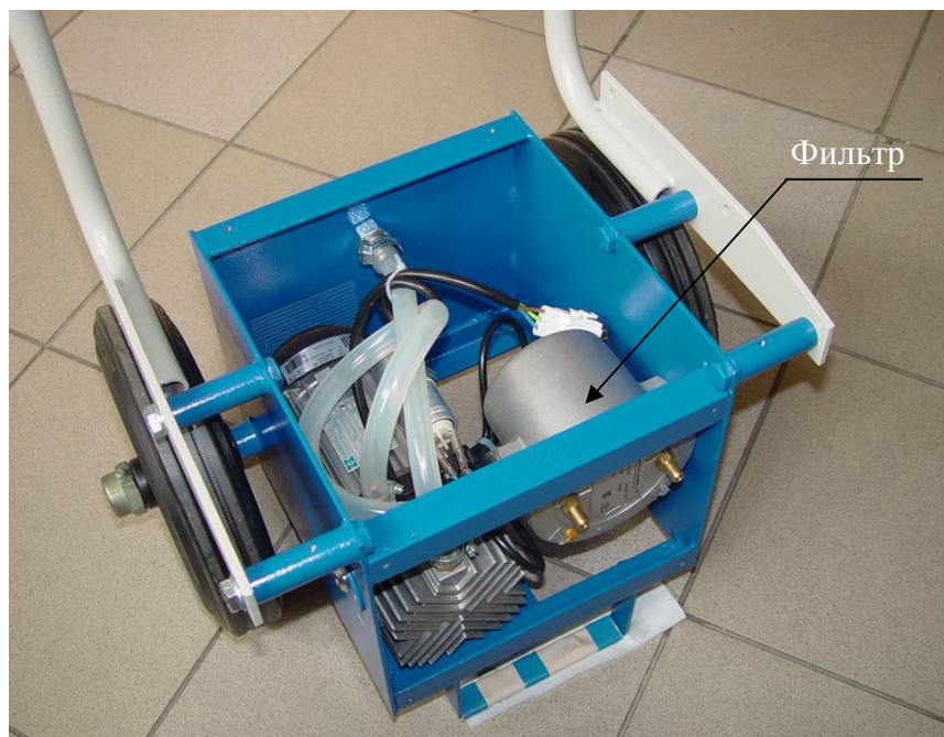
Рисунок 3.4 – Замена фильтрующего элемента
