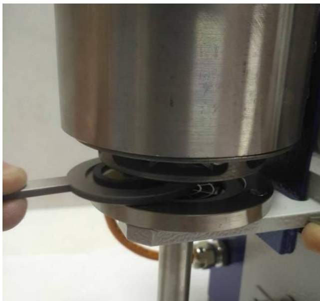
Рисунок 3.10 – Установка контрольного источника
