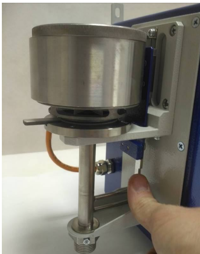
Рисунок 3.11 – Фиксация контрольного источника
