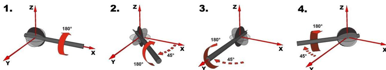
8. После завершения вращений по п.п.5–7 остановить измерение клавишей СТОП индикаторного блока. Записать значение максимальной напряженности МП или ЭП в выбранной полосе частот
