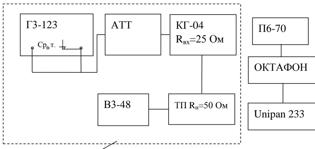
Приборы и устройства из состава РЭНМП-05Г/10М
