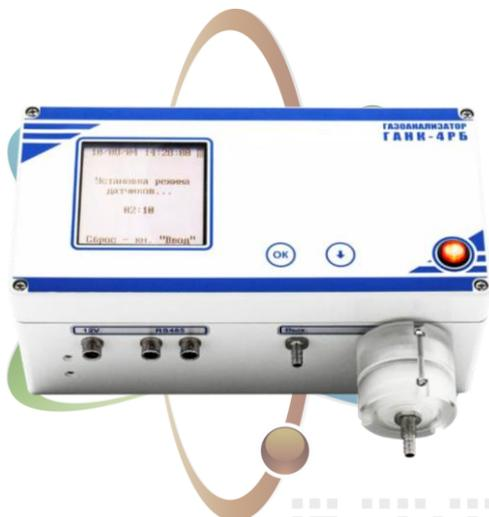
Восьмиканальный автоматический **стационарный газоанализатор ГАНК-4РБ** непрерывного действия с принудительным отбором проб, с сигнализацией превышения настроенных порогов срабатывания, с цифровым выходом RS-485 с протоколом MODBUS RTU. Преимущественно применяется для непрерывного контроля воздушной среды на содержание опасных концентраций анализируемых веществ как в воздухе рабочей зоны, так и в атмосферном воздухе в составе автоматических систем контроля качества воздуха с целью:
