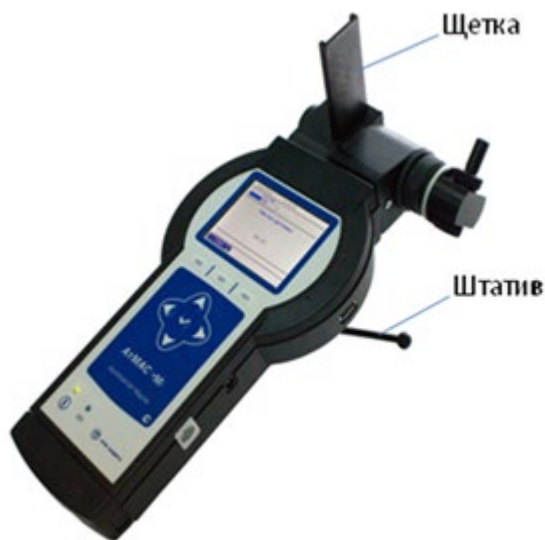
Рисунок 17 – Размещение очищающей щетки в анализаторе
